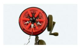
11 / Sollte der Faden nicht unter die roten Stege gleiten, sondern an ihnen hoch stehen, ist die Fadenspannung zu gering und das Gewicht muss weiter nach oben gehängt werden. Should the wool not slip under the white bars, rather sit above them, the wool tension is too low and the weight should be hung further up.
