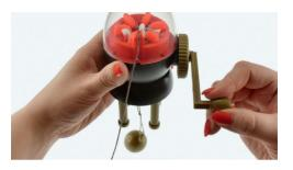
Nun einfach an der Kurbel drehen und die Kordel kommt unten zum Vorschein. Wenn die Kordel mit dem Gewicht den Boden berührt, muss das Gewicht umgehangen werden. Now, simply continue to turn the crank and you will begin to see the cord appear underneath. When the cord with the weight touches the work surface below, the weight must be re-hanged.
